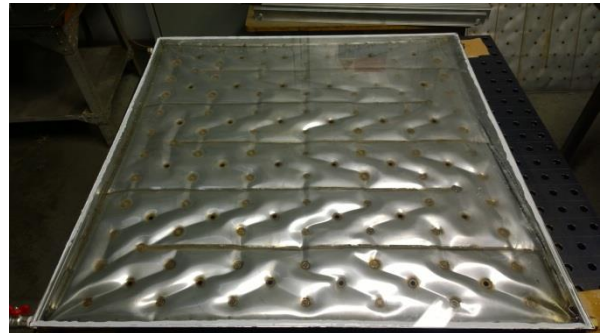
Obr. 4b Solární kolektor po tlakové zkoušce
