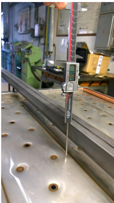
Obr. 4c Princip měření vydutí solárního absorbéru
