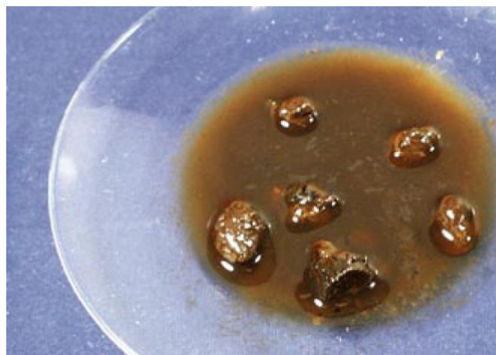
Obr. 2 Vznik pevné inkrustace v teplotnosné kapalině
