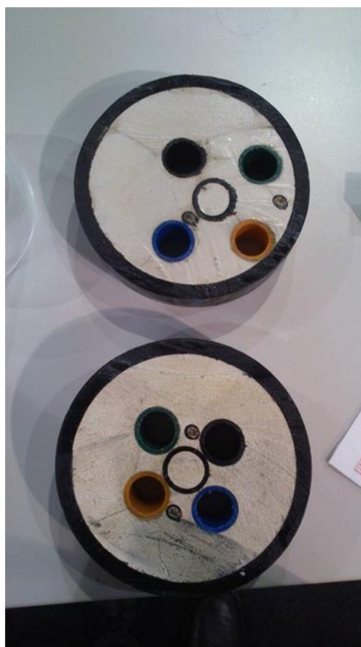
Obr. 6 Kontrola injektáže vrtů pro tepelná čerpadla, měření tepelných odporů vrtů (zdroj: Stavební geologie - Geosan s.r.o.)
