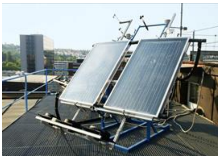
Obr. 2 Testovaný prototyp zaskleného FVT kolektoru v solární laboratoři UCEEB (vlevo) a v experimentální instalaci na střeše Fakulty strojní (vpravo) ČVUT v Praze
