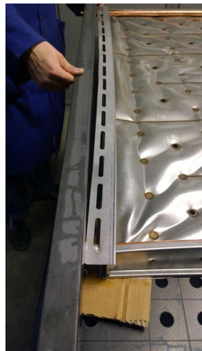
Obr. 4e Deformace bočnic po testu
