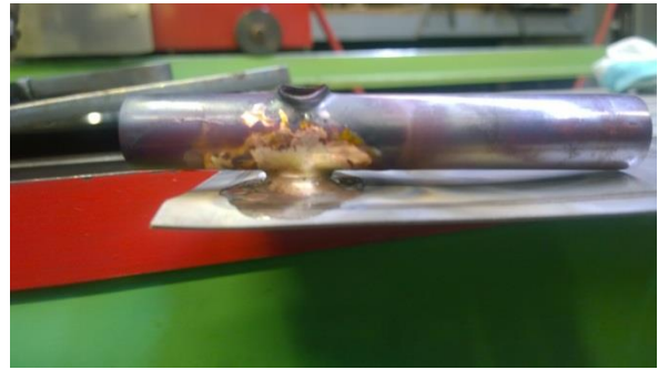
Obr. 3b Zkouška pájení mezi vyhrdlením trubky a hrdlem na absorbéru
