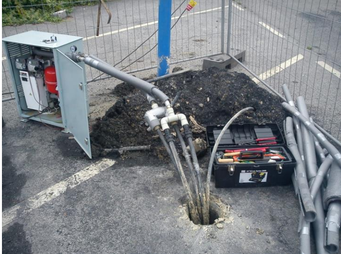
Obr. 4 Měření tepelných parametrů hornin v terénu tzv. TRT test (zdroj: Stavební geologie - Geosan s.r.o.)
