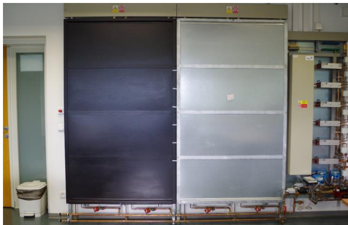
Obr. 3 Sestava povrchově upraveného a neupraveného akumulčního panelu
