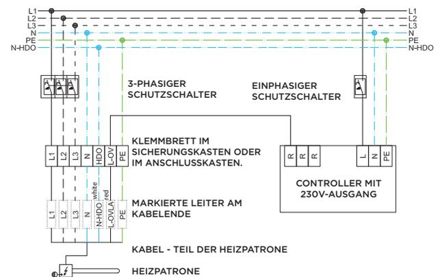
Steuerung über integrierten Thermostat ohne Rundsteuerung
