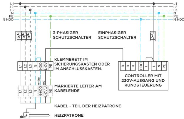
Steuerung über externen Controller ohne Rundsteuertechnik
