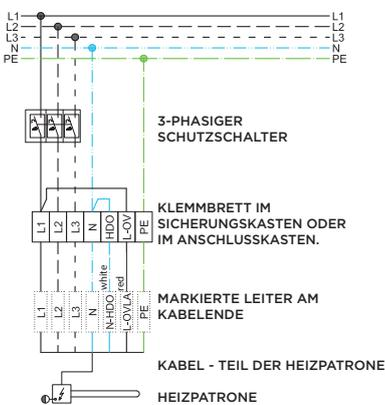
Steuerung über integrierten Thermostat mit Rundsteuerung
