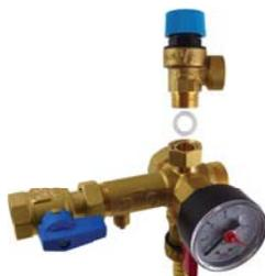
Das Sicherheitsset dient zum Schutz des Warmwasserspeichers vor Überschreitung des maximalen Betriebsdrucks, zur Überprüfung der Funktion des Rückschlagventils und zur Entleerung des Warmwasserspeichers. Es enthält ein Sicherheitsventil, Rückschlagventil mit Funktionskontrolle, Kugelhahn, Ablassventil und Manometer.
